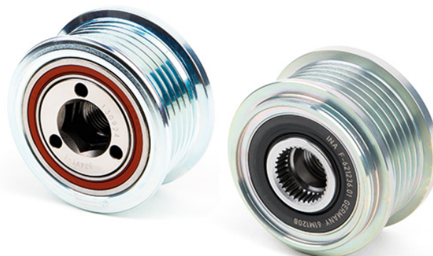
Photo : Différences d'aspect de la poulie à roue libre d'alternateur réf. 535 0303 10
