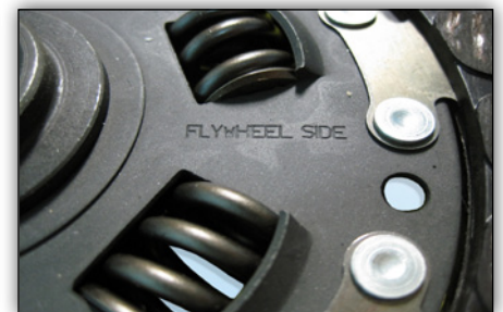
Image 1 à 4 : Inscriptions possibles sur le disque d'embrayage
