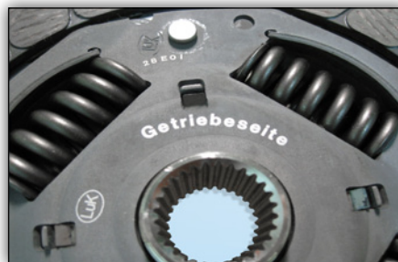
Image 1 à 4 : Inscriptions possibles sur le disque d'embrayage
