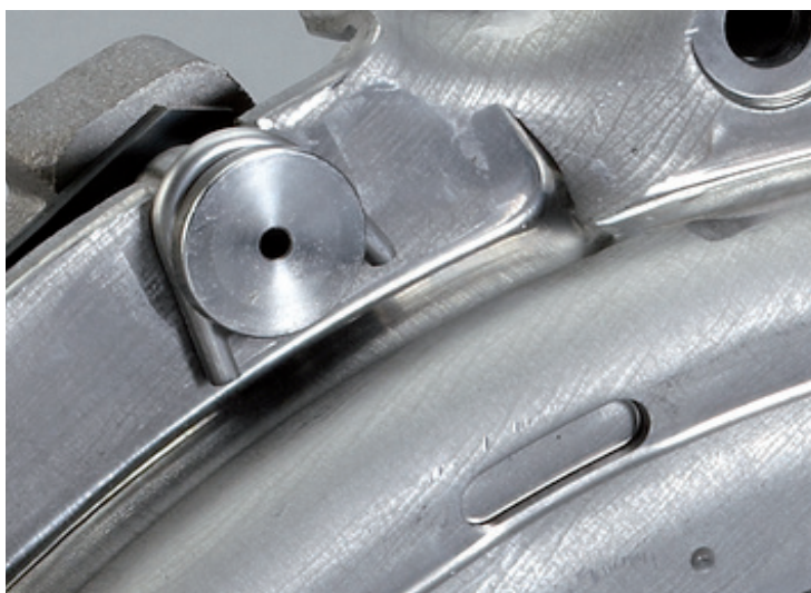
Photo 2 : Les supports de montage sont placés entre les boulons et le carter de l'embrayage
